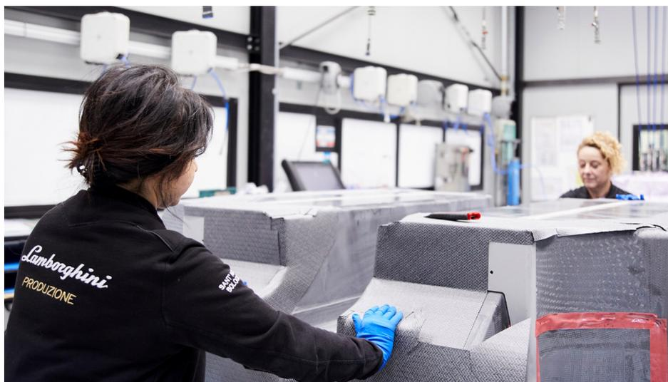
La production de pièces en polymères renforcés de fibres carbonées (PRFC) est coûteuse, car elle exige un savoir-faire pointu et de nombreuses tâches manuelles. BMW a tout de même automatisé en partie la fabrication des carrosseries en PRFC. Source : Lamborghini
