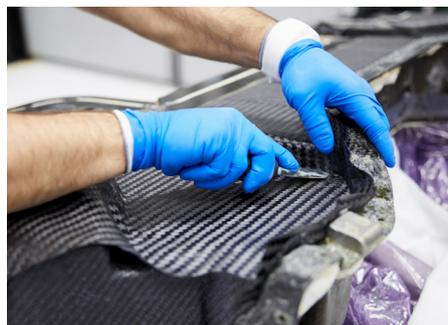
Les plaques de fibres de carbone doivent être laminées à la main dans les moules des modèles. Cela alourdit énormément le processus de production, c'est irréalisable pour les grandes séries. Source : Lamborghini
