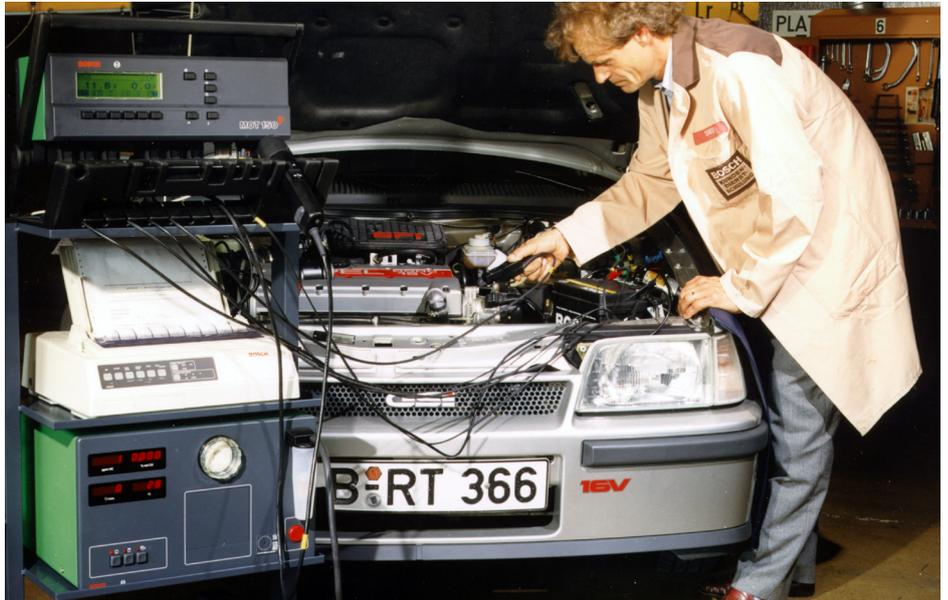
Dès 1993, un testeur de moteur (en haut) et un testeur de gaz d'échappement (en bas) faisaient partie des outils de diagnostic de l'atelier et aidaient les techniciens à identifier les erreurs. Photo : Robert Bosch GmbH, Archives des entreprises
