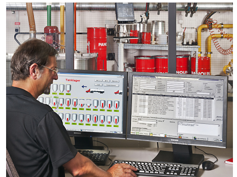
Les installations de production assistées par ordinateur permettent de mélanger l'huile avec précision. Photo: Panolin
