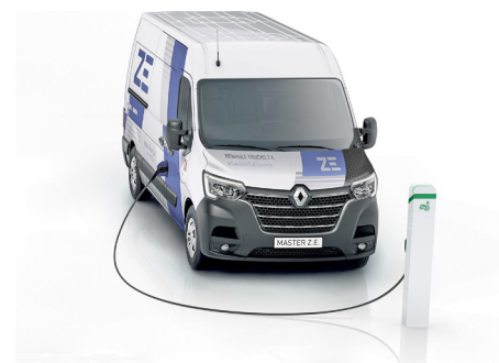
Du côté des véhicules utilitaires légers, le moteur électrique à batterie est la technologie la plus judicieuse. Là aussi, plus l'autonomie visée est importante, plus la batterie est lourde et plus la charge utile se réduit. Photo : Renault
