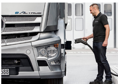
Un véhicule utilitaire doit rouler pour être rentable. Par conséquent, le temps de recharge est important. Les bornes de recharge rapide CC permettent d'atteindre 80 % de la capacité / de l'autonomie en deux heures. Photo : Mercedes-Benz
