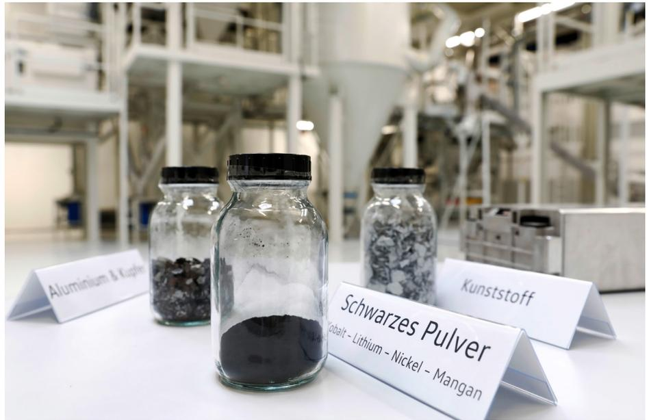
L'électrolyte, l'aluminium et le plastique peuvent être aisément séparés lors du recyclage de batteries de traction. Les métaux précieux sont éliminés sous forme de poudre noire. Photo: VW
