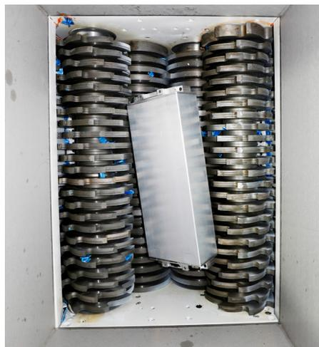
Les batteries sont broyées mécaniquement et désosées d'abord à la main. Ces deux méthodes font l'objet d'études. Photo: Volkswagen
