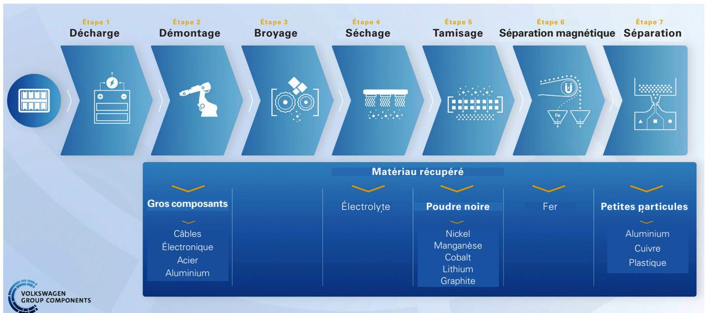
La protection de l'environnement et le développement durable sont d'importants moteurs pour l'industrie automobile. Le recyclage de tous les composants d'un véhicule et de sa batterie n'en est encore qu'à ses balbutiements. Des usines de recyclage capable de décomposer de gros volumes de batteries de traction en leurs constituants individuels sont en cours de construction. Photo: VW
