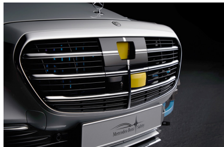
Pour son assistant sur autoroute de niveau 3 SAE, la nouvelle Classe S est dotée, en plus du radar longue portée, d'un capteur lidar (contre supplément). La redondance permet une conduite autonome jusqu'à 60 km/h dans les embouteillages sur l'autoroute. Source : Mercedes-Benz
