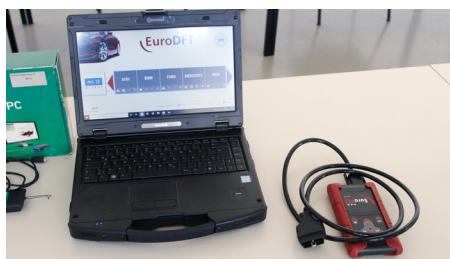
Des fournisseurs de diagnostic indépendants tels qu'EuroDFT proposent un accès sans problèmes aux différents portails OEM et fournissent le matériel nécessaire. Source : Se.
