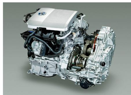
Le précurseur de l'hybride à répartition de puissance : la Toyota Prius est équipée d'un moteur à combustion et de deux moteurs/générateurs électriques pour une conduite à variation continue. Source : Toyota.
