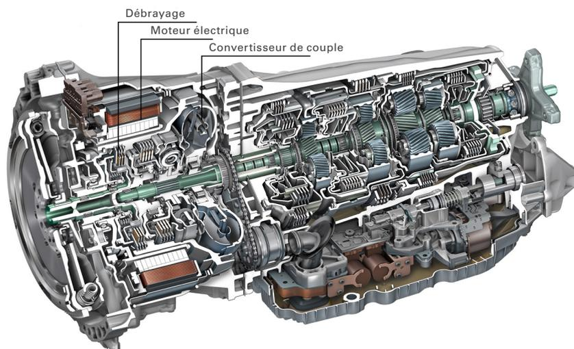
Neuf vitesses et un moteur électrique intégré pour les moteurs hybrides rechargeables : Mercedes construit elle-même ses boîtes avec un grand savoir-faire en matière d'intégration système. Source : Mercedes-Benz.
