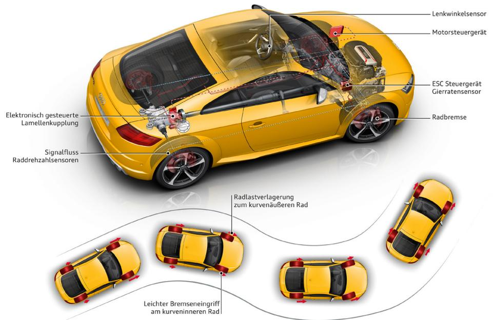
Grâce aux interventions de freinage et à la régulation motrice, les véhicules maintiennent leur trajectoire même à la limite physique. Cette performance est rendue possible grâce à la puissance de calcul élevée et à la mise en réseau des systèmes. (Photo: Audi)
