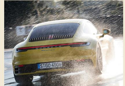
Grâce à deux micros logés dans chacun des passages de roue avant, l'actuelle Porsche 911 détecte la réduction du frottement liée à la pluie et conditionne les systèmes de contrôle du châssis de manière préventive.
