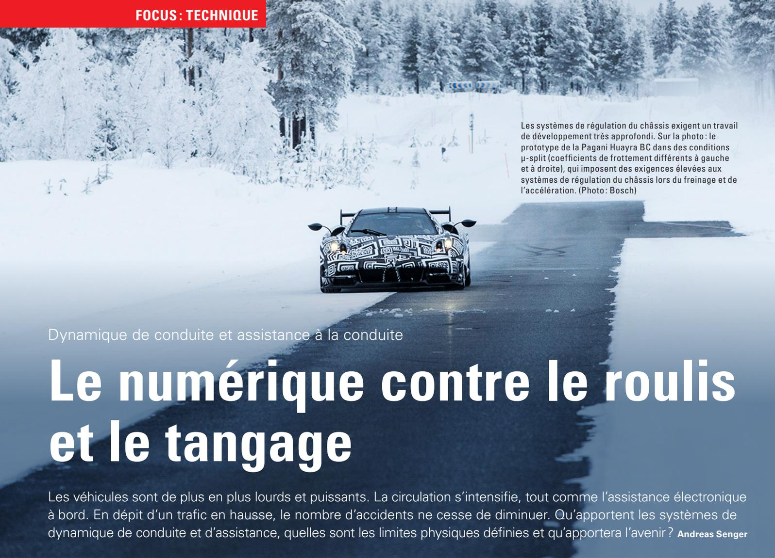
Les systèmes de régulation du châssis exigent un travail de développement très approfondi. Sur la photo: le prototype de la Pagani Huayra BC dans des conditions  $\mu$ -split (coefficients de frottement différents à gauche et à droite), qui imposent des exigences élevées aux systèmes de régulation du châssis lors du freinage et de l'accélération. (Photo: Bosch)
